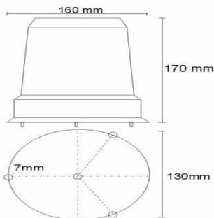
**Spannung: 12-24VDC , 15 Watt**
